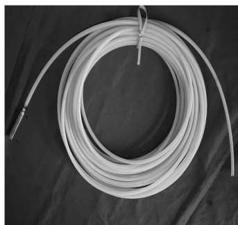
手动惯性取样泵及其管线
