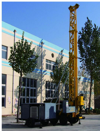
图1 分体式XD-3型全液压力头式钻机
