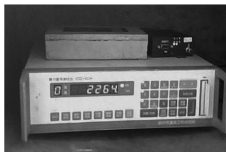
图3 JCQ-503A型静载荷测试仪
