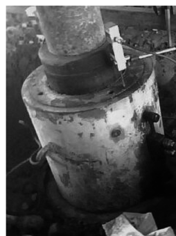
图2 位移计的安装
