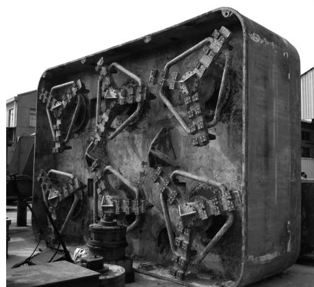
图7 拉顶结合新型矩形掘进机
