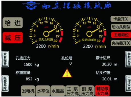
图5 显示在主界面上的随钻测深数据
