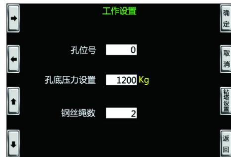
图 4 恒压钻进控制系统设置界面
