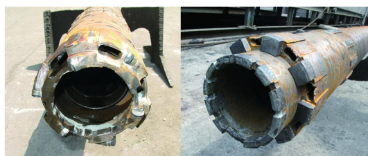
图 7 超前式隔水防冲蚀取心钻头
