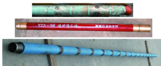
图 6 螺杆马达、液动锤和长半合管取心钻具
