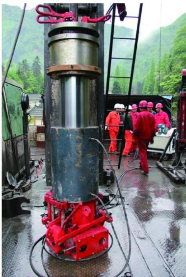
图8 BC250型拔管机
