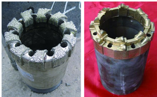
图2 部分取心钻进用钻头
