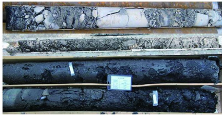
图 4 WFS-3 孔破碎砂岩及煤线岩心
