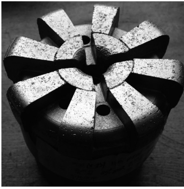
图 4 二次镶嵌式金刚石造斜钻头
