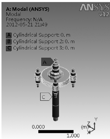
图 1 齿轮副三维实体模型及约束添加图
