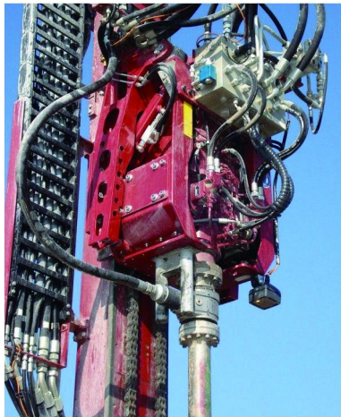
图4 回转声波动力头图片
