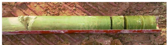
图 11 单管钻具取出的岩心
