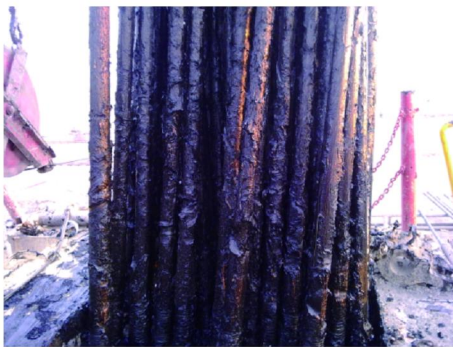
图 4 芳 180 - 斜 146 井钻具外壁粘附情况
