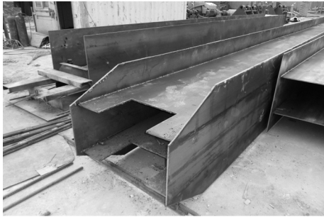
图7 已制作成品钢箱接头
