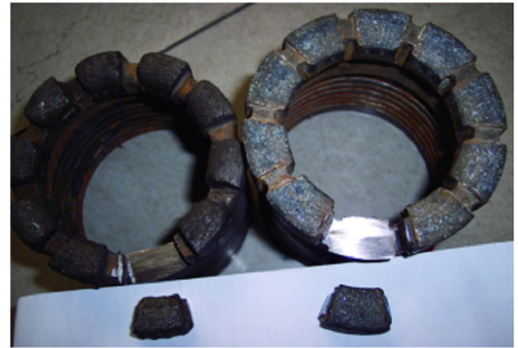
图 10 探工所钻头(左)和普通钻头(右)
