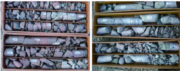
(a) 破碎岩心 (b) 严重破碎岩心
