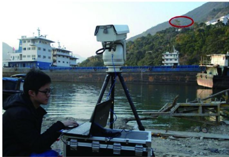
图 8 在滑坡侧面对准靶标放置的可视化监测仪器系统
