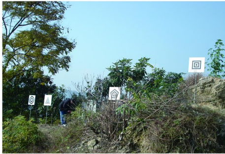
图 7 滑坡中部安装的 4 个不同靶标
