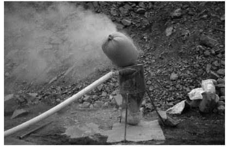
图 8 用编织袋在下收集岩样,用大的布口袋在上收集粉尘
