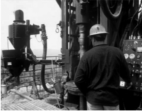
图 2 RD10 + 钻机的螺旋/旋转湿式分离系统
