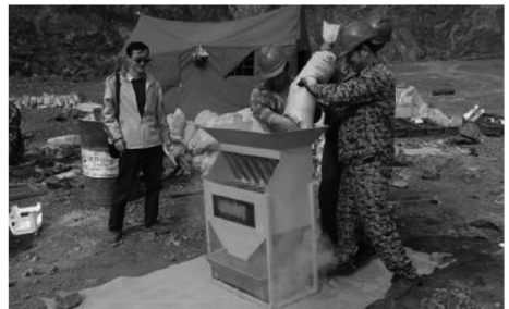
图14 用二分器对岩样进行缩分
