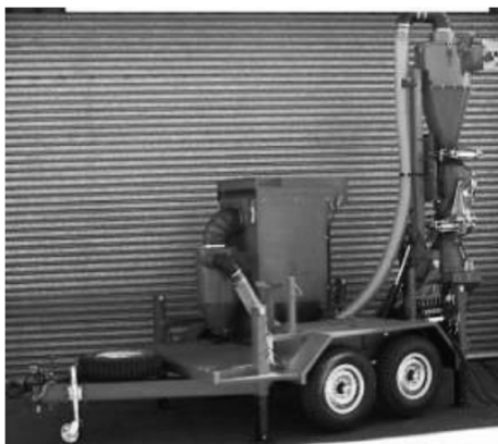
图16 可旋转的圆锥缩样器拖车取样系统
