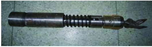
图1 锚索孔内装置
