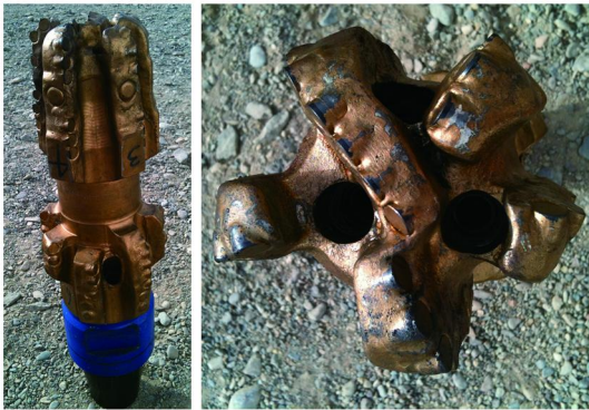
图4 CSDR5211S-B2型随钻扩眼钻头实物图
