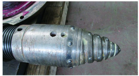
图4 试验用单头螺旋冲击矛头
