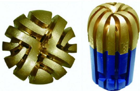
图8 孕镶金刚石钻头冠部类型图
