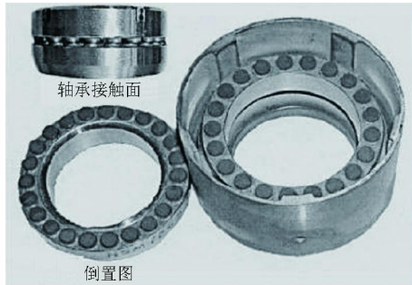
图2 涡轮钻具PDC止推轴承示意图
