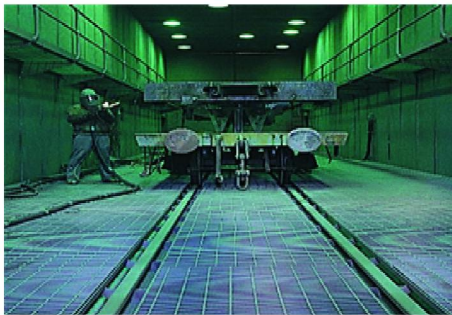
图5 PQF 12.9 m × 6 m × 4 m 喷漆房作业现场
