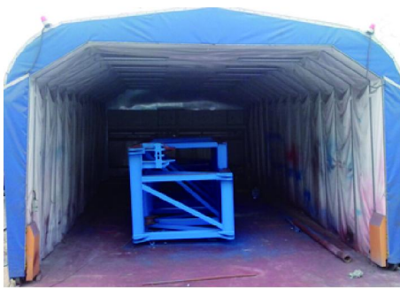
图6 PQF 12.9 m × 6 m × 4 m 喷漆房作业完成情况
