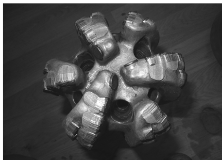
图 1 钻头被磨损出环形槽
