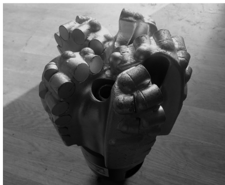
图 2 哈里伯顿 FX55D 型钻头
