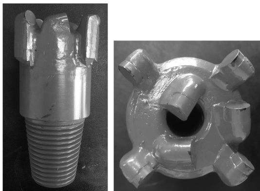
图 3 平底型 PDC 钻头
