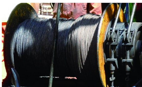
图1 常规绳索取心绞车钢丝绳排列紊乱
