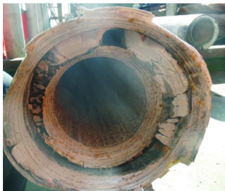
图7 出井双层套管切割口
