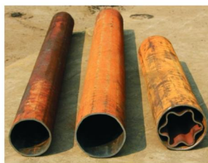
图 12 膨胀完成的波纹管实物
