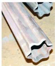
图 11 加工完成的波纹管实物
