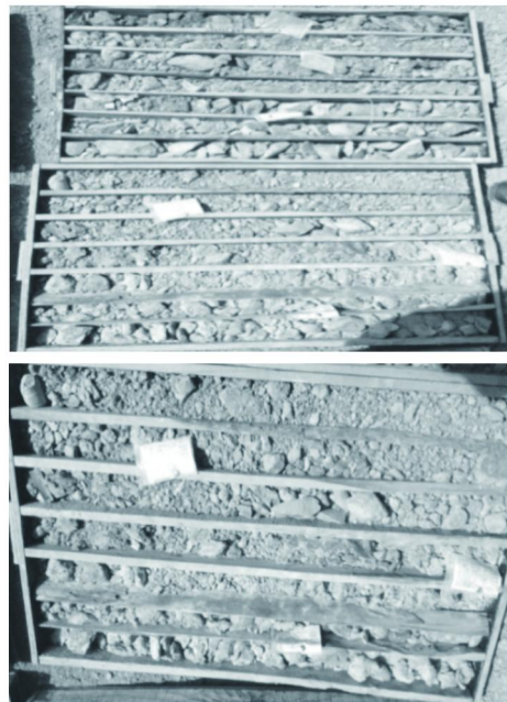
图 2 现场取出的破碎、松散岩心
