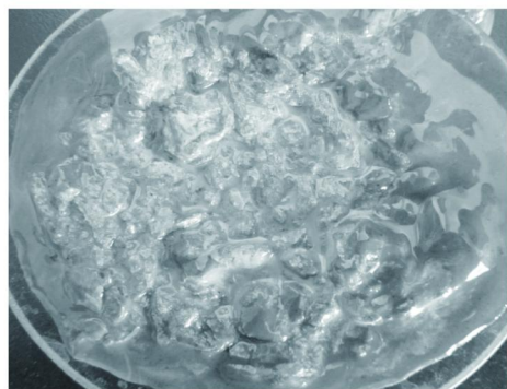
图 8 用“8% 膨润土 + 1% 腐植酸钾 + 0.1% HV - CMC”浸泡 24 h 后松塌
