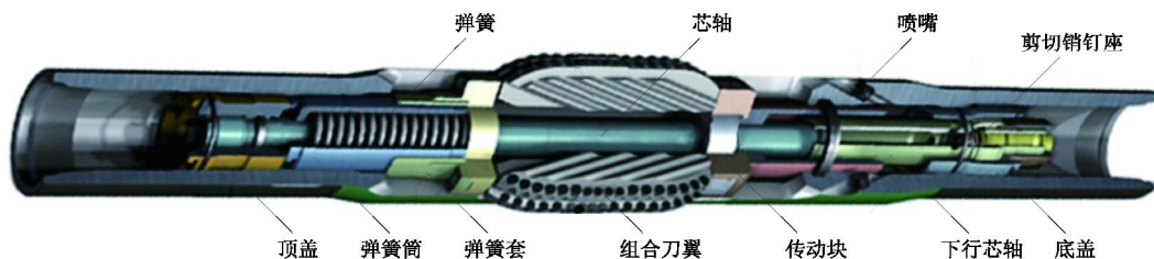
图 1 单球投入式扩眼器结构示意图
