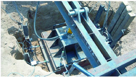
图 5 土方直剪试验设备
