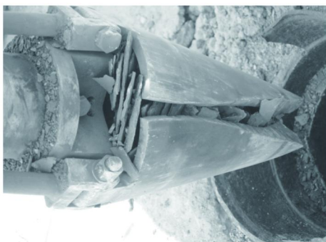
图2 井内打捞出的铁锈皮
