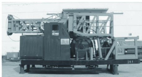
图 1 YCJF - 25 型钻机全景图片
