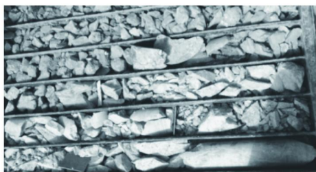
图 4 现场取出的灰岩地层岩心
