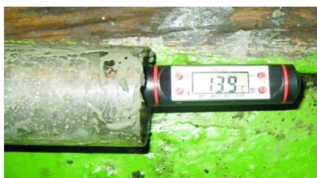
图 14 常规取样筒出井后样品温度
