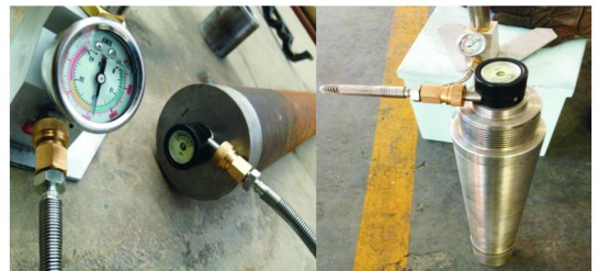
图 5 取样器保压机构性能测试图
