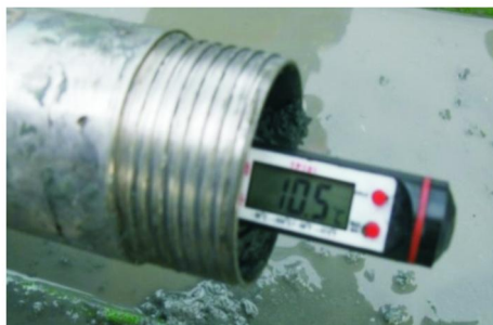
图 13 保温取样筒出井后样品温度
