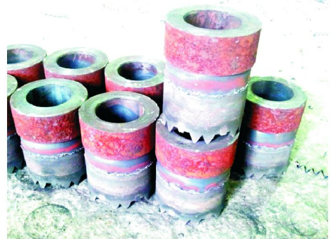
图 12 完成烧结的金刚石钻头
