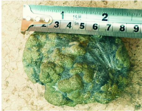
图7 井深665.50 m时井底捞取的坍塌块
