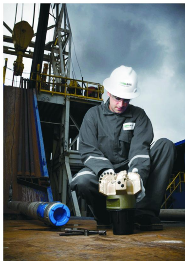
图 5 工程师在检查 ONYX II 4 刀翼矛式 PDC 钻头
