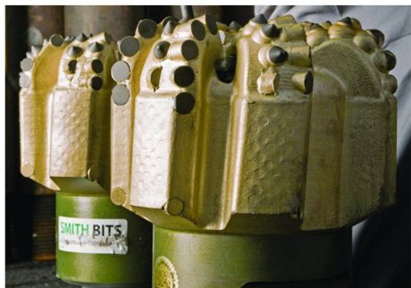
图3 StingBlade 毒牙刀翼 PDC 钻头
