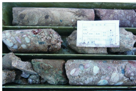
(2) 用成膜体系后现场取出的松散含砾岩心
