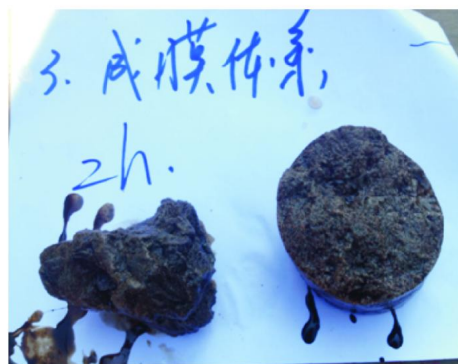
图5 成膜体系浸泡 2 h 后的岩块
