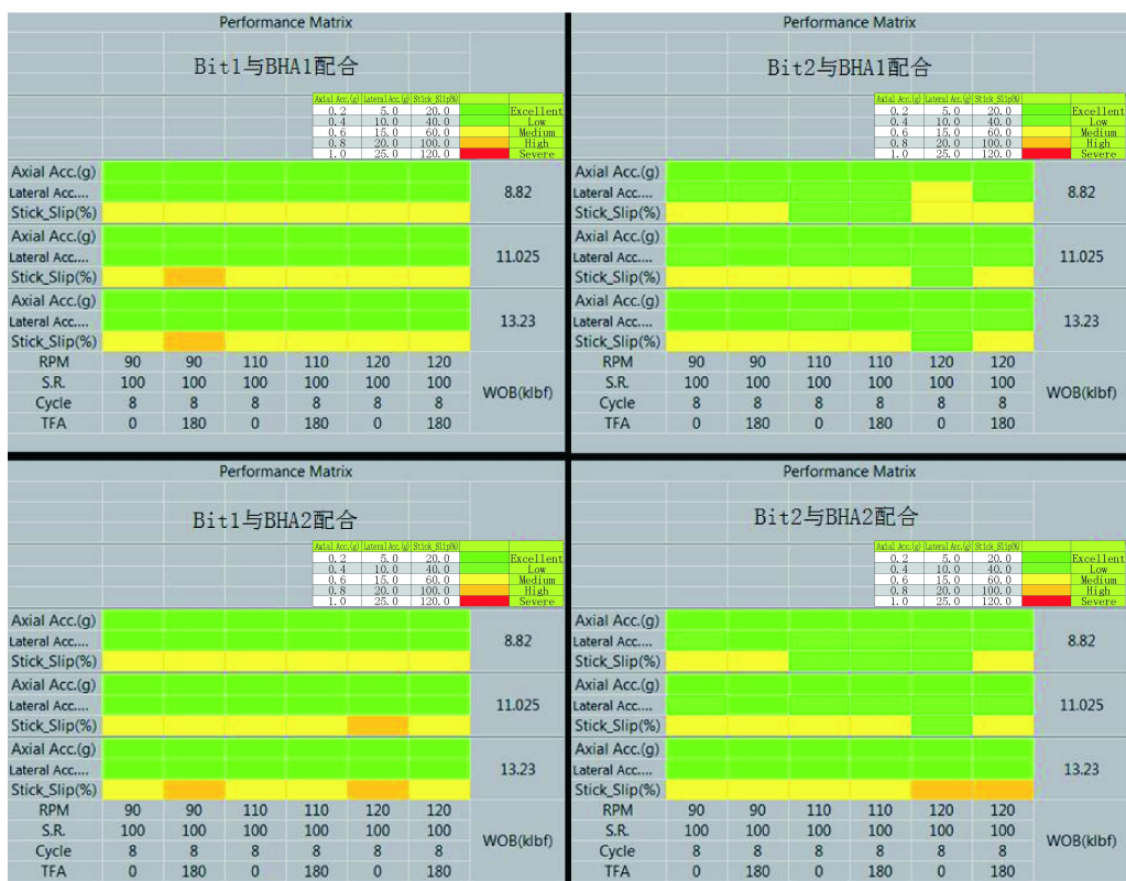
图6 钻进软地层震动模拟结果
