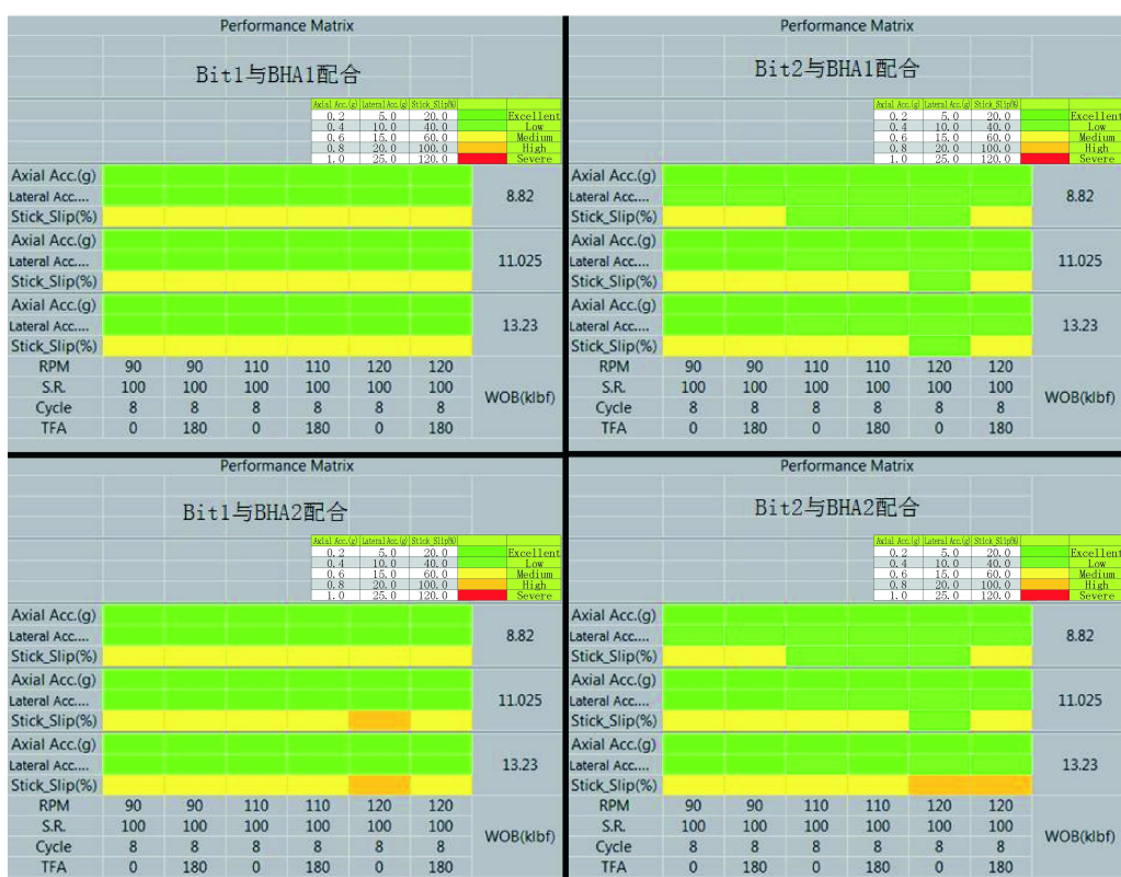
图6 钻进软地层震动模拟结果
