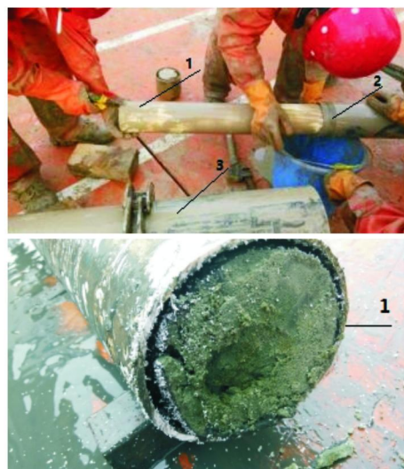
1—PVC岩心管;2—内管;3—外管
