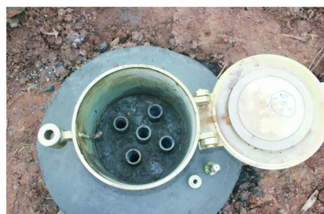
图11 五层巢式监测井
