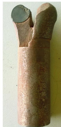
图6 锚杆钻头崩片、保径失效
