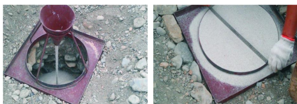
图 5 现场干密度试验(灌砂法)
