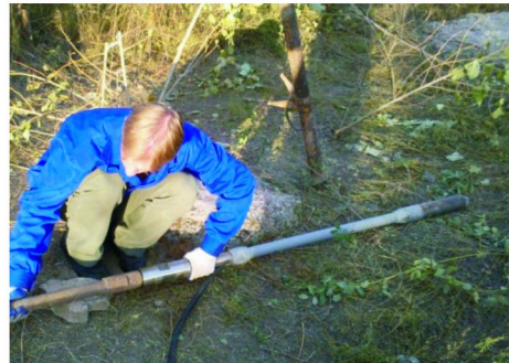
图 2 俄罗斯专家正在安装放电设备
