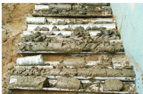
图12 普通钻具取出的岩矿心
