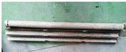
图10 打开半合管带有护心管的岩矿心
