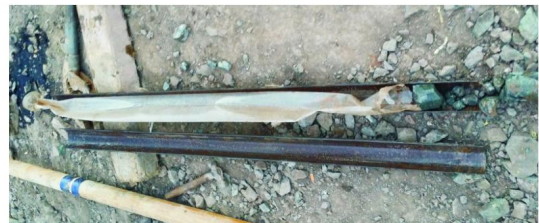
图9 岩矿心破碎护心管被挤压断裂
