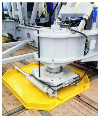
图 6 Independence 公司 201 型钻机(1500 hp) 步进系统 4 个“步行鞋”之一
