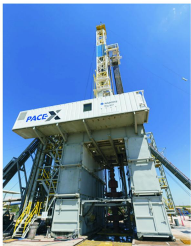
图7 Nabors 公司 PACE - X 新型工厂化作业钻机在施工现场
