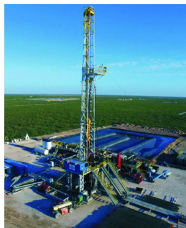
图 4 在二叠纪盆地施工的 Independence 公司的 210 型页岩钻探钻机
