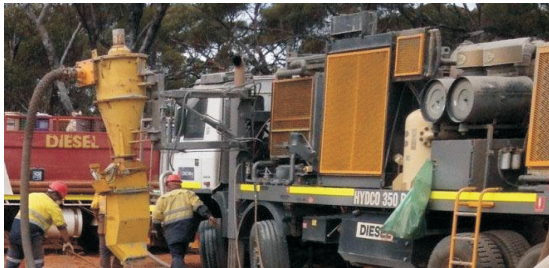
图1 取样、缩分一体的采样系统
