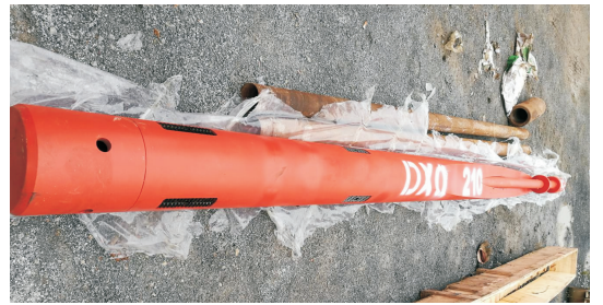
图 2 DXQ210/H 型管内液压悬挂式导斜器
