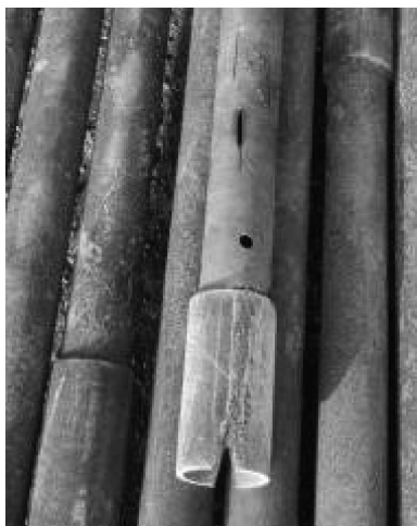
图 8 套管底部通水槽/打孔
