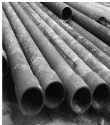
图6 \Phi 127 mm 套管/ \Phi 146 mm 外箍
