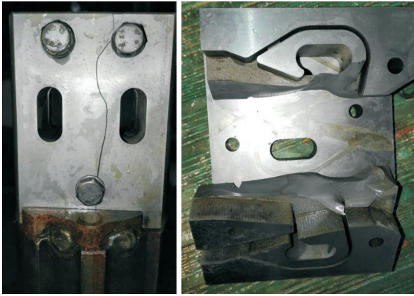
图 1 地面钻进试验过程中硬质合金射流元件遭受冲击破坏
