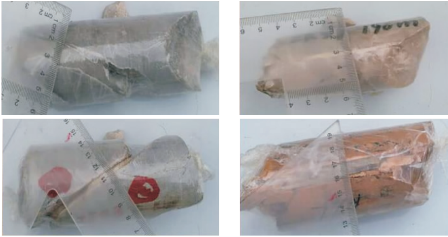
图1 岩心裂隙充填水泥照片
