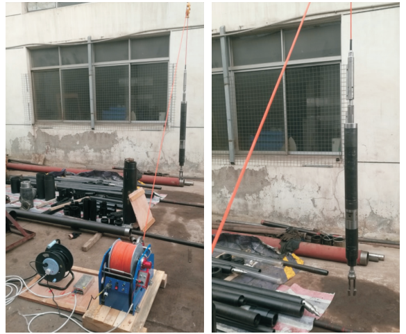
图 5 泥皮清理装置室内实验
