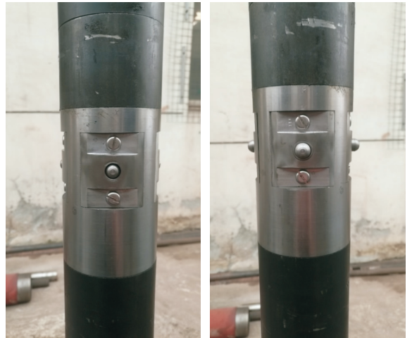
图 6 刮泥器反扭总成工作状态
