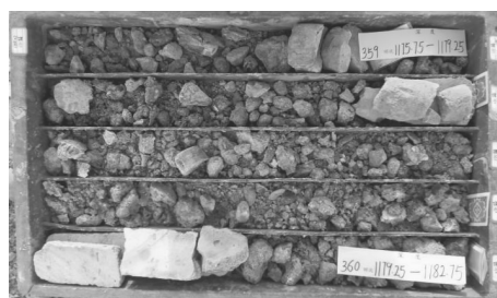
图 2 卵砾石层及砂层孔段岩心(1175~1182 m)
