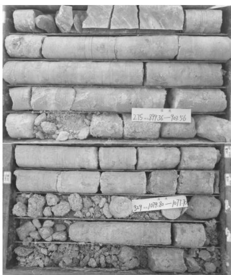
图 6 易吸水膨胀的粘土层孔段岩心
