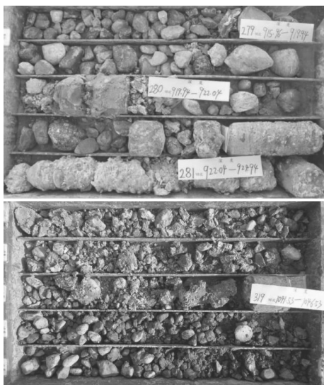
图 5 松散破碎的卵砾石层及砂层孔段岩心
